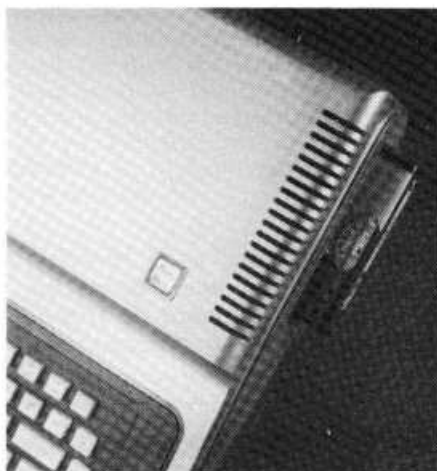
Afb. 3. In een gleuf aan de zijkant kunnen de programmamodulen worden geschoven.
